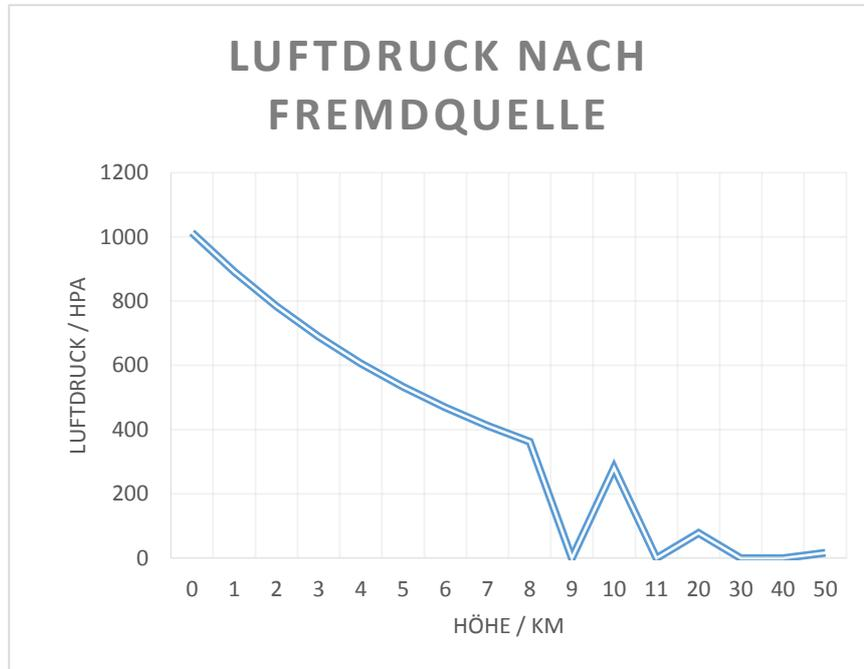
Da die errechneten Werte sehr stark von den in der Fremdquellen angegebenen Werten abweichen, ist klar, dass innerhalb der Berechnungen ein Fehler vorgefallen sein muss. Dieser konnte allerdings immer noch nicht festgestellt werden. Es wird in Frage gestellt, ob der Luftdruck wirklich unter Verwendung der idealen Gasgleichung
