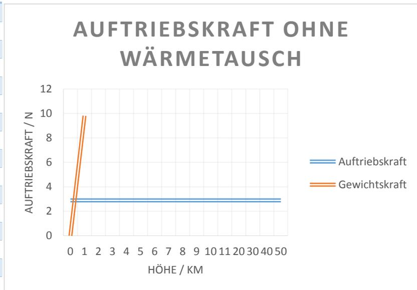
Man kann sehen, dass die Auftriebskraft bei konstanter Temperatur im Ballon gleich bleibt und keine Beeinflussung durch die äußeren Begebenheiten stattfindet.
